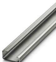
Carril simétrico sin perforar, según EN 60715, material: Acero, galvanizado, pasivado de capa gruesa, Perfil G, color: plateado, Variante de embalaje con 10 unidades (20 m)
