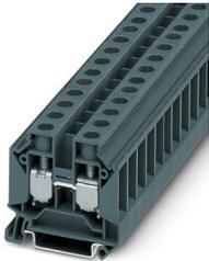
Borne de paso, tensión nominal: 1000 V, corriente nominal: 76 A, tipo de conexión: Conexión por tornillo, Sección de dimensionamiento: 16 mm<sup>2</sup>, sección: 6 mm<sup>2</sup> - 16 mm<sup>2</sup>, clase de montaje: NS 35/7,5, NS 35/15, NS 32, color: gris oscuro
