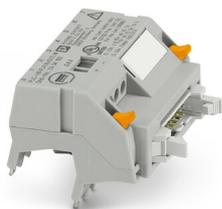
Adaptador V8 para 8 x PLC-INTERFACE (6,2 mm), control: Sistema de cableado PLC de tarjetas de salida, conexión 1: Conexión por tornillo 1x, conexión 2: Conector macho IDC/FLK 1x 14-polos, conexión 3: Conexión enchufable (Encajable en 8x bornes PLC-INTERFACE), número de canales: 8, lógica de mando: minusschaltend
