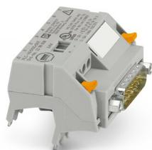
Adaptador V8 para 8 x PLC-INTERFACE (6,2 mm), control: Sistema de cableado PLC de tarjetas de salida, conexión 1: Conexión por tornillo 1x, conexión 2: Conector macho D-SUB 1x 15-polos, conexión 3: Conexión enchufable (Encajable en 8x bornes PLC-INTERFACE), número de canales: 8, lógica de mando: plusschaltend
