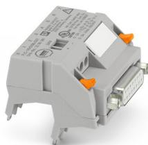
Adaptador V8 para 8 x PLC-INTERFACE (6,2 mm), control: Sistema de cableado PLC de tarjetas de salida, conexión 1: Conexión por tornillo 1x, conexión 2: Hembra de conexión D-SUB 1x 15-polos, conexión 3: Conexión enchufable (Encajable en 8x bornes PLC-INTERFACE), número de canales: 8, lógica de mando: plusschaltend
