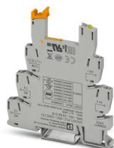
Borne de base PLC de 6,2 mm con conexión por tornillo, sin equipamiento de relé o relé de estado sólido, para montar sobre carril NS 35/7,5, 1 contacto conmutado, tensión de entrada 24 V DC
