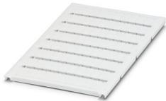
Marcador para bornes, Estera, blanco, sin rotular, rotulable con: BLUEMARK ID COLOR, BLUEMARK ID, BLUEMARK CLED, PLOTMARK, CMS-P1-PLOTTER, clase de montaje: enclavar, para ancho de borne: 6,2 mm, superficie útil: 5,6 x 10,5 mm, Número de índices individuales: 80
