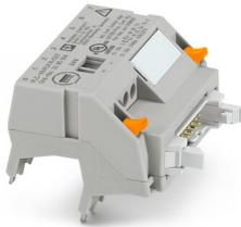
Adaptador V8 para 8 x PLC-INTERFACE (6,2 mm), control: Sistema de cableado PLC de tarjetas de salida, conexión 1: Conexión por tornillo 1x, conexión 2: Conector macho IDC/FLK 1x 14-polos, conexión 3: Conexión enchufable (Encajable en 8x bornes PLC-INTERFACE), número de canales: 8, lógica de mando: plusschaltend
