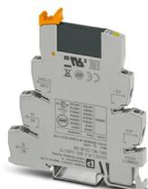
PLC-INTERFACE, compuesto de borne de base PLC-BSC.../21 con conexión por tornillo y relé de estado sólido en miniatura enchufable, para el montaje en carril NS 35/7,5, 1 contacto de cierre, entrada: 24 V DC, salida: 3-33 V DC/3 A
